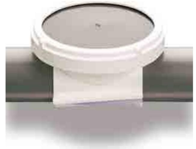
Lorsque le débit d'air est désactivé, la pression de l'eau au-dessus appuie fortement le disque à membrane contre la plaque de support, ce qui provoque la fermeture des fentes de la membrane. La soupape anti-retour se referme et vérifie que l'eau ne pénètre pas dans les conduites.
