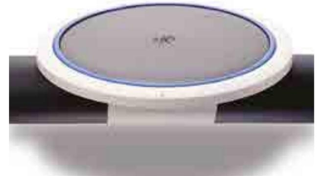
Lorsque le débit d'air est désactivé, la pression de l'eau au-dessus appuie fortement le disque à membrane contre la caisse principale, ce qui provoque la fermeture des fentes de la membrane. La soupape anti-retour, avec bille en acier inoxydable enfoncée fermement sur un joint torique à l'intérieur, se referme et vérifie que l'eau ne pénètre pas dans les conduites. Pendant le fonctionnement normal, la soupape anti-retour sert également d'orifice de contrôle.
