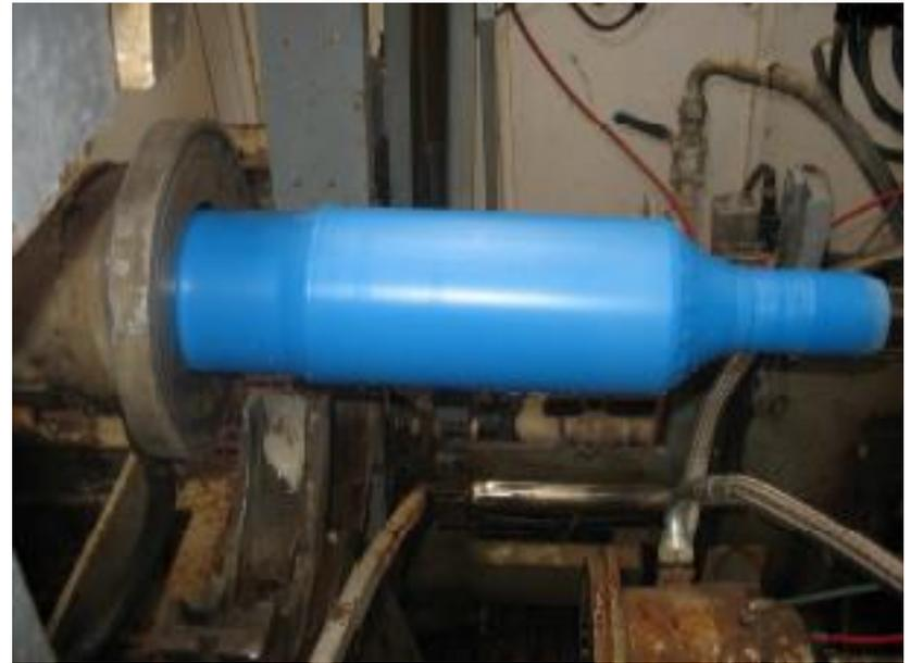
**Adequa a développé un procédé exclusif de conception de la partie évasée correspondant au logement du joint qui permet de garantir une meilleure étanchéité du tube**
