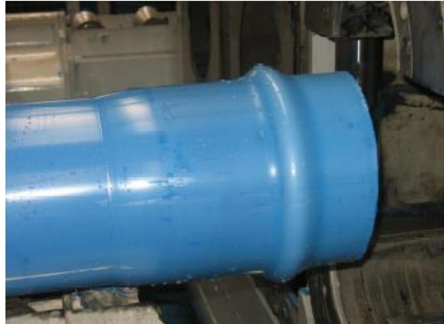
**Cela améliore l'ancien système qui consistait à réaliser ce logement dans le moule d'orientation, cet ancien système étant toujours utilisé par d'autres fabricants**
