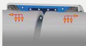
Fixation axiale avec 3 bagues de crampage
