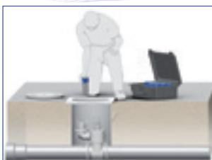
Installation des loggers sur le réseau par les bouches à clé
