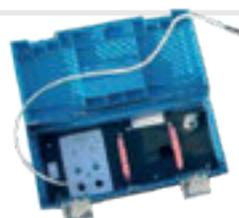
Repérage du tracé de la conduite à l'aide du boîtier de commande AQUA M300 et d'une cloche d'écoute (voir p.16-17)
