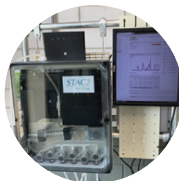
6 STAC2 • Analyseur en ligne pour la mesure de NO 3 , DCO, COT, DBO, MES
