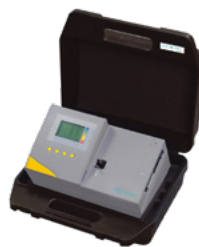
Analyseur DCO, DBO, COT, NO 3 sans réactif
